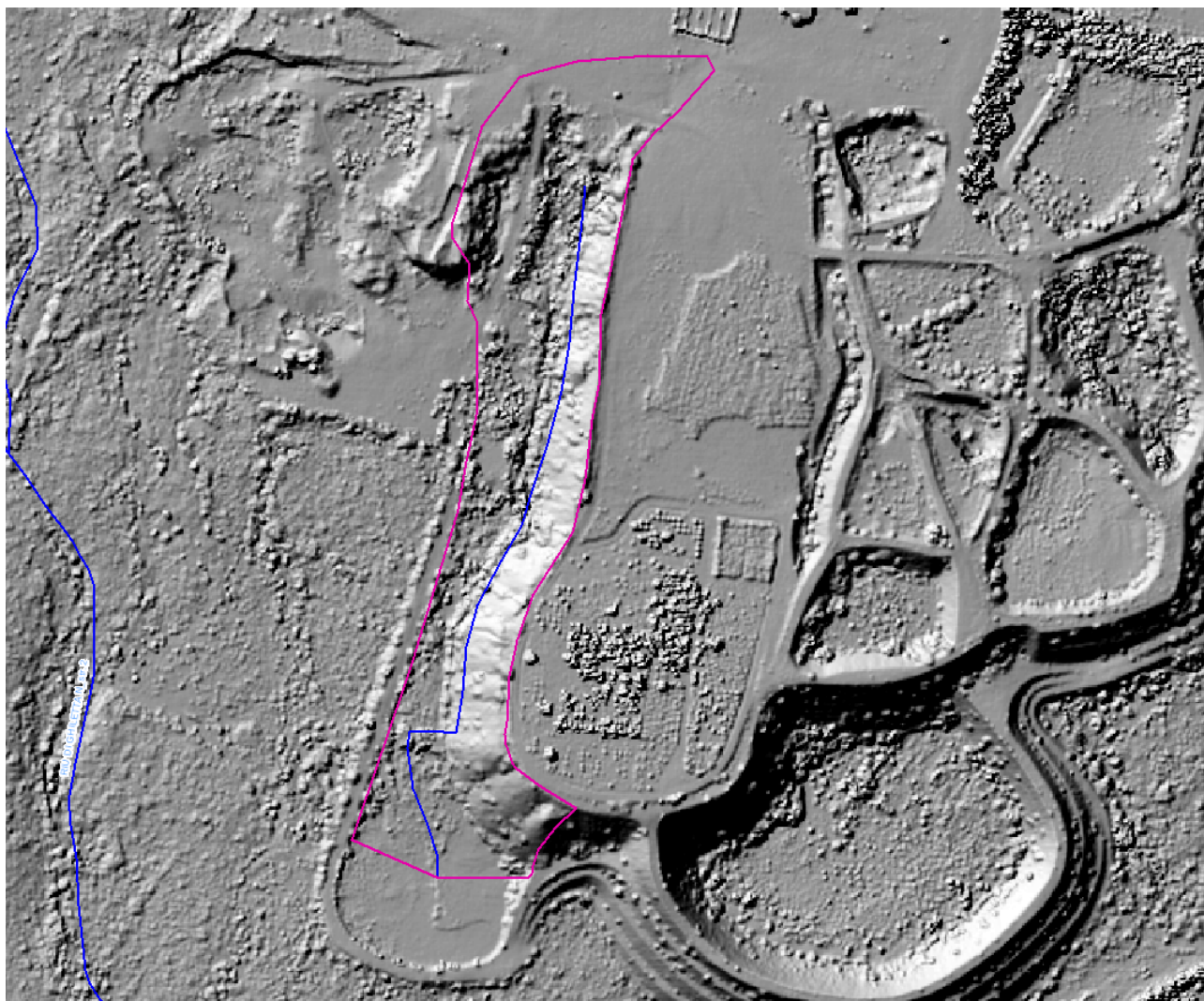
Definizione sul DSM del 2008 del bacino superficiale sotteso dall'elemento idrico 107008_FIUME_21123
