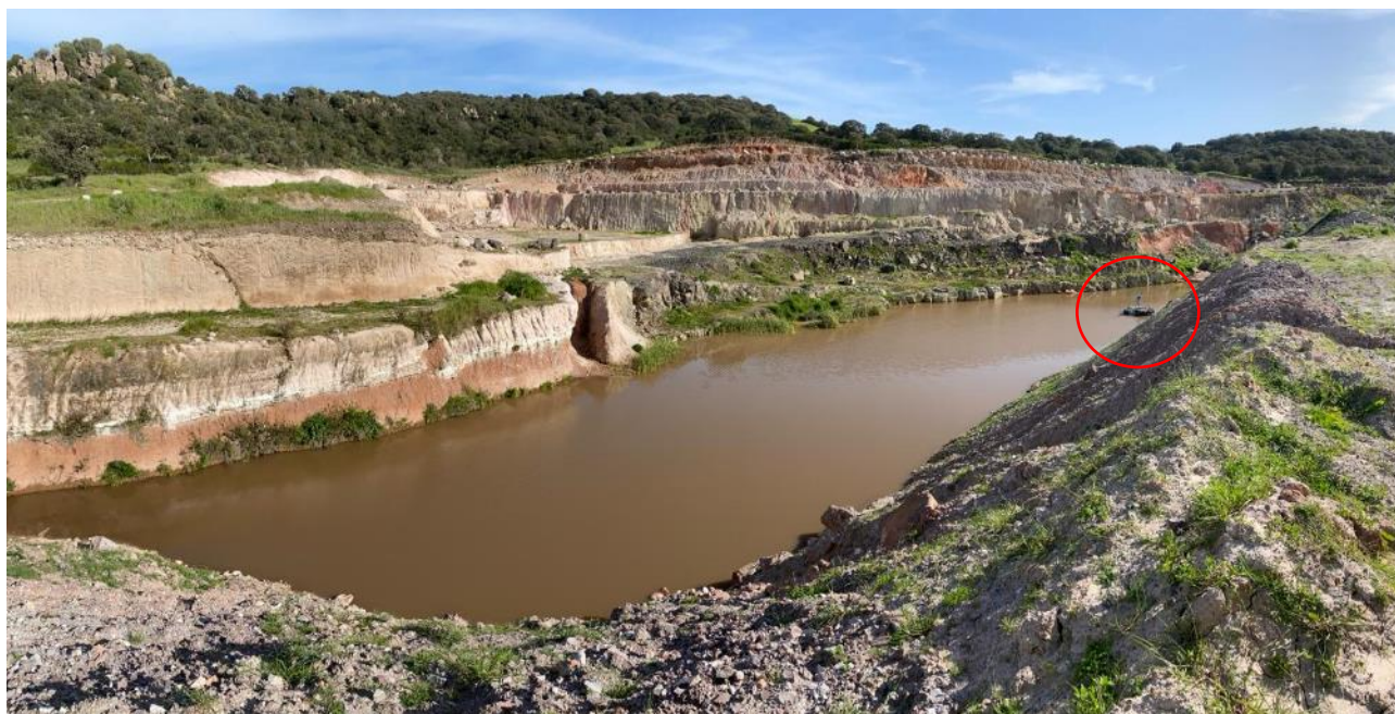
Fotografia 19: Cantiere Dore S. cerchiato il sistema di eduazione su zattera
