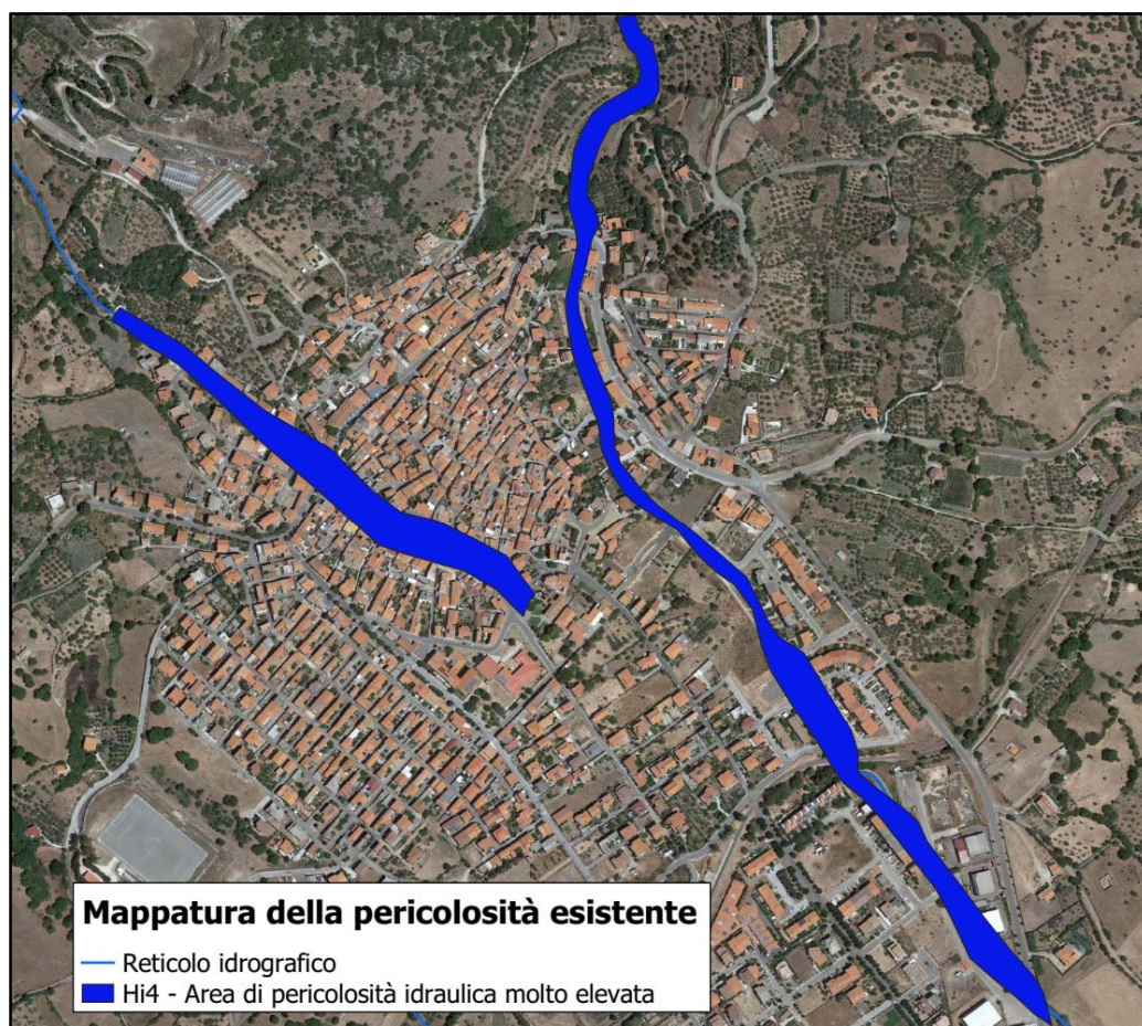
Figura 4 – Perimetrazione della pericolosità idraulica sul bacino del Rio Funtanedda
