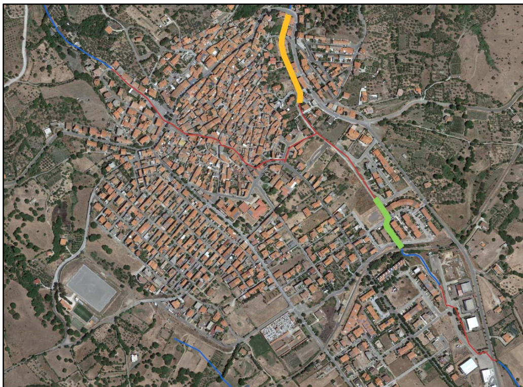
Figura 6 – Planimetria degli interventi realizzati negli anni ottanta, in verde il canale realizzato nell'allora "Piano di Zona 167" e in giallo il tratto iniziale a valle dell'attraversamento sul Corso Vittorio Emanuele
