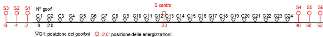
Figura 47 Schema geometrico di acquisizione dei dati per gli stendimenti di lunghezza L = 46,0 m
