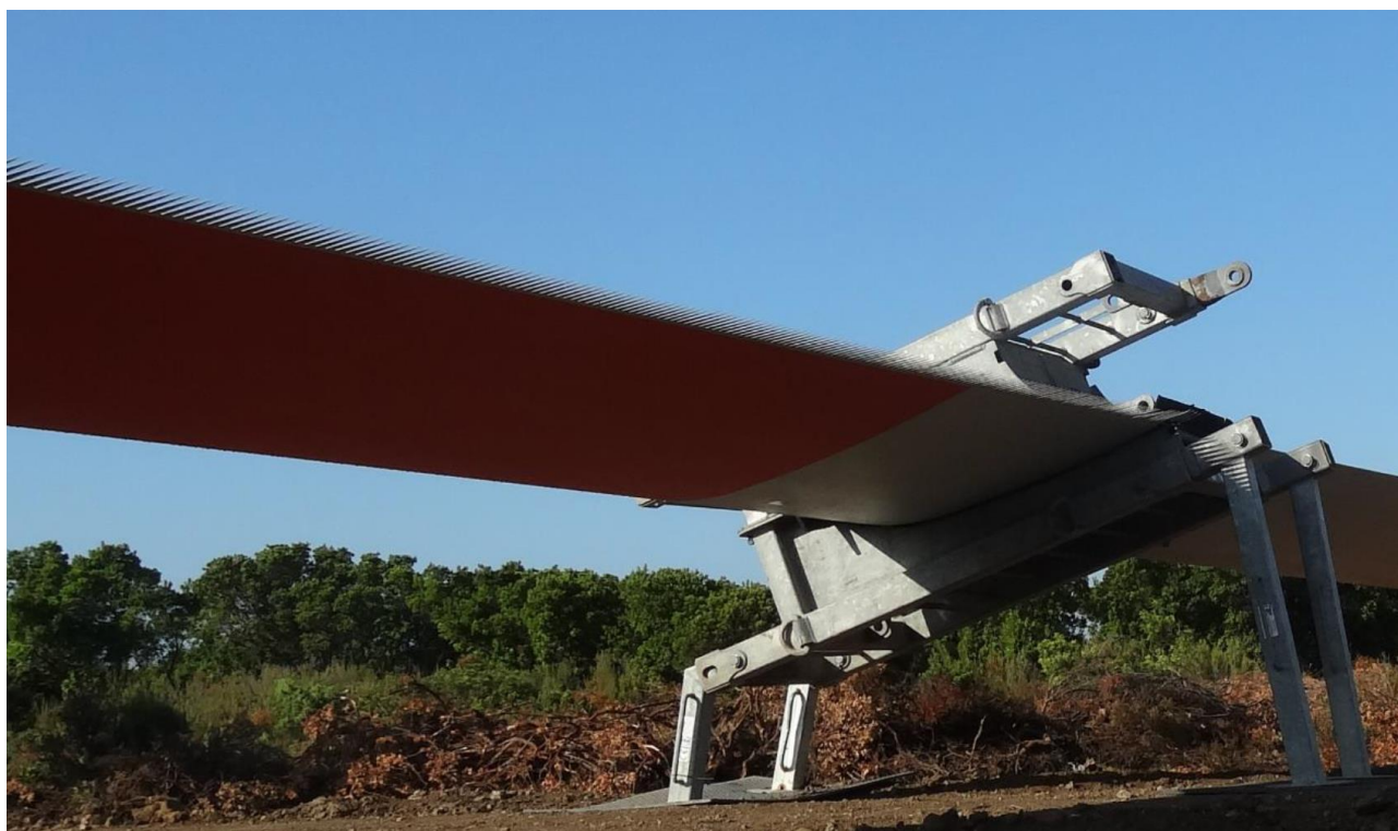
Figura 39: pala di aerogeneratore con bande dentellate.
