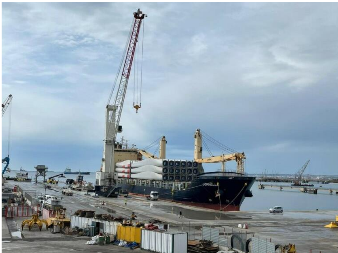
Figura 161: esempio della nave cargo “Johnelle” che scarica 18 aerogeneratori (pale con relativi equipment: navicelle, generatori, sezioni di tronco, ecc.) nel porto di Augusta, in Sicilia. Fonte: https://www.shippingitaly.it/2023/05/08/esordio-di-est-terminal-nel-porto-di-augusta-con-uno-sbarco-di-project-cargo/rgo/
