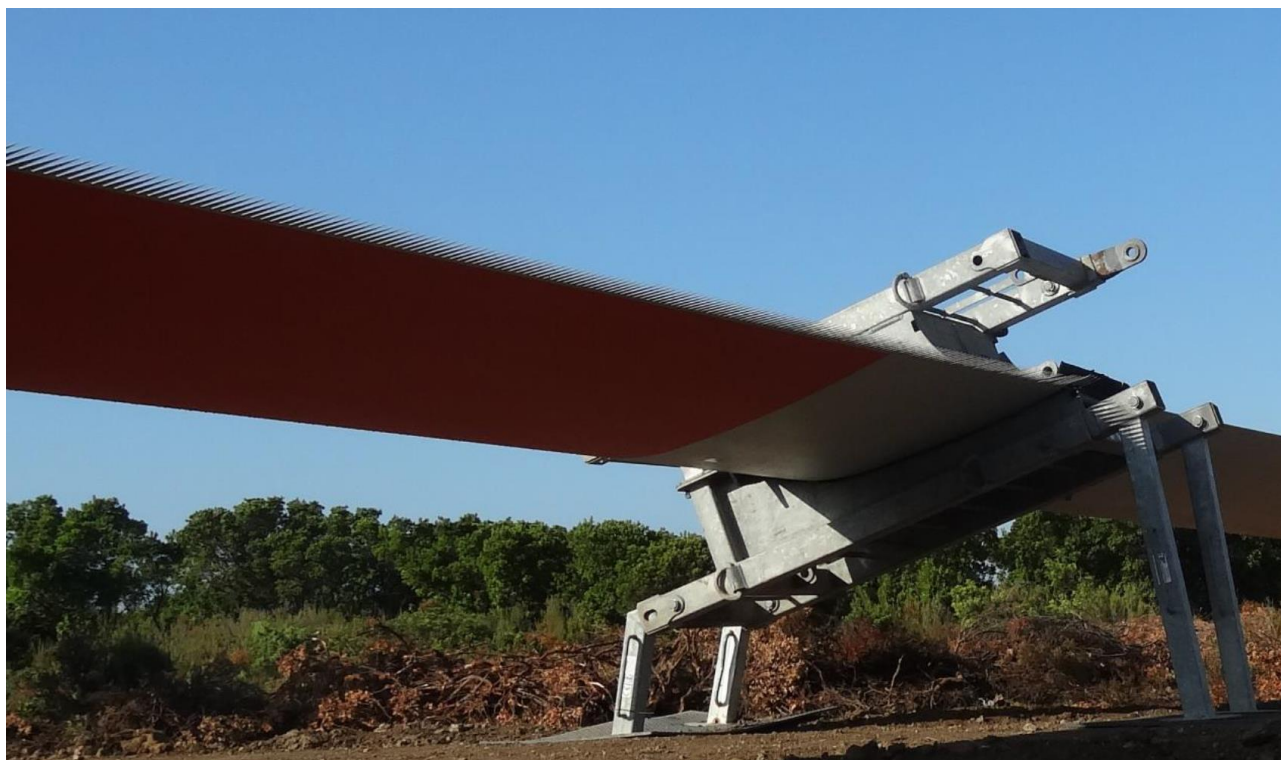
Figura 151: pala di aerogeneratore con bande dentellate.
