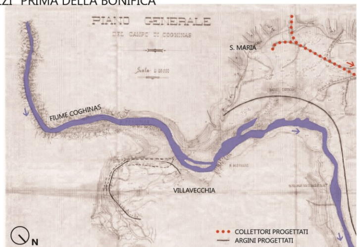
1908 - PLANIMETRIA DEL PIANO GENERALE DELLE OPERE DI REGIMAZIONE FLUVIALE E BONIFICA DEL CAMPO DI COGHINAS, REALIZZATA DAL GENIO CIVILE DI SASSARI
