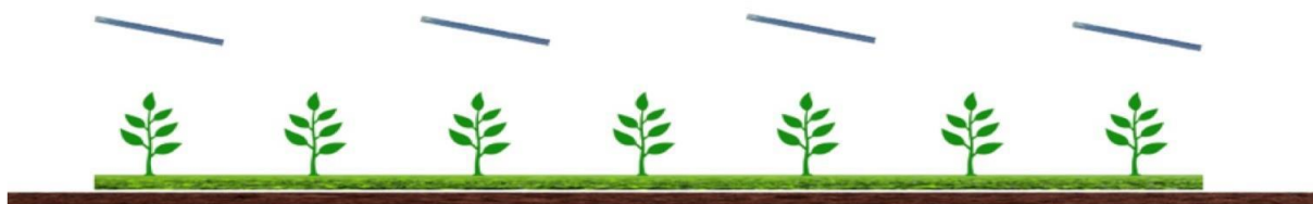
Figura 2.27 – Esempio sistema agrivoltaico in cui la coltivazione avviene tra le file dei moduli fotovoltaici, e sotto a essi (Fonte: Linee Guida in materia di Impianti Agrivoltaici – Giugno 2022)
