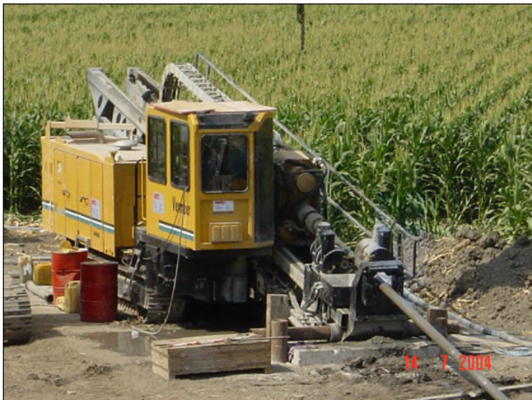
Figura 20 – Vista di un RIG di perforazione per T.O.C.
