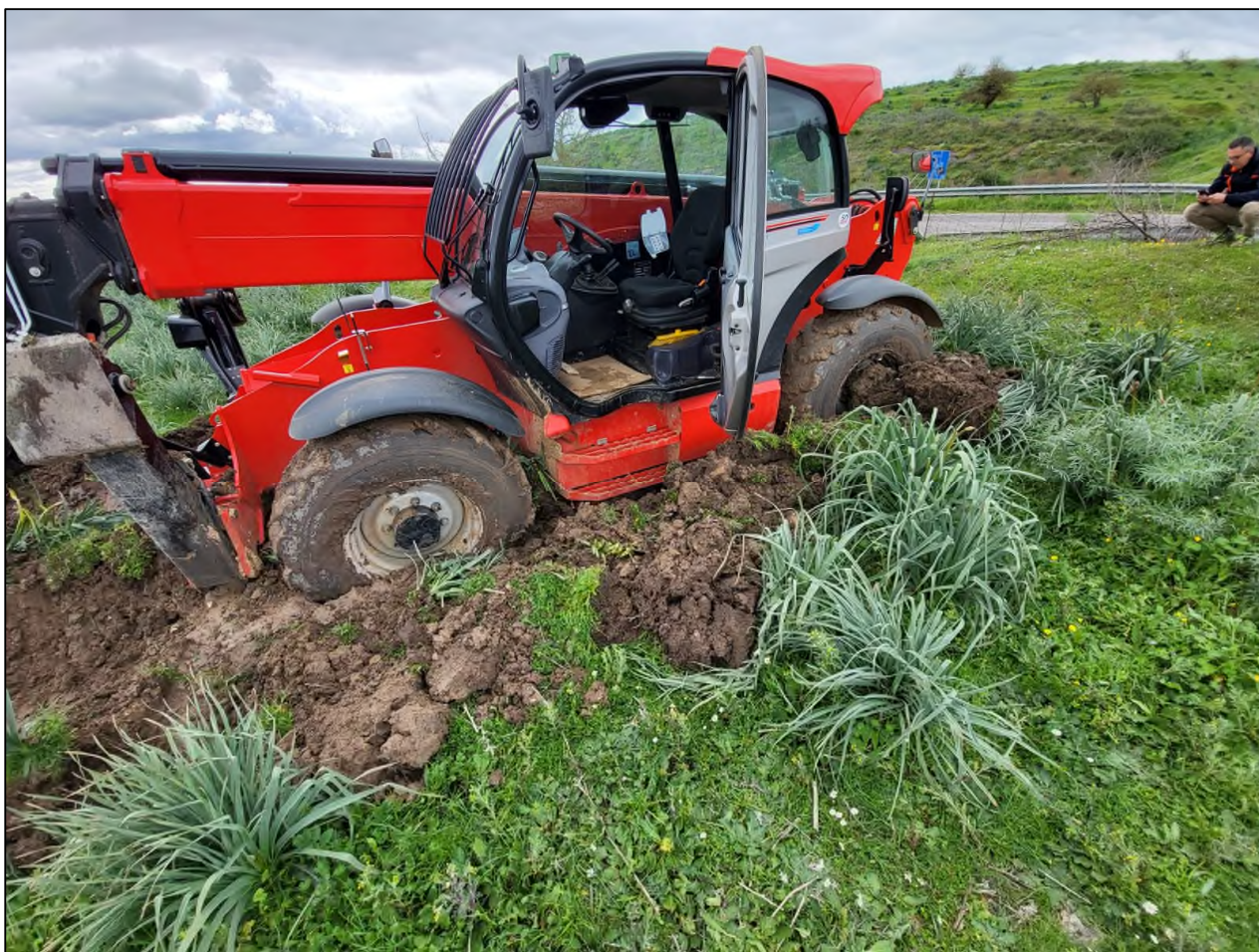
Figura 9 – Vista del Manitou MT 1440 affondato nel terreno
