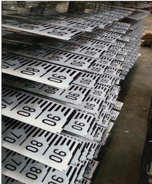
Figura 14 Immagine tipologica asta idrometrica
