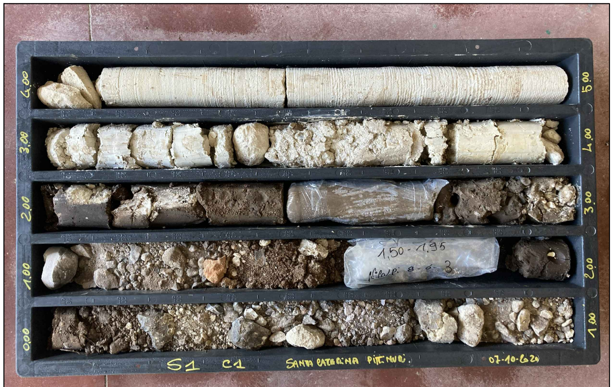
SONDAGGIO 1 - Cassa 1 (da m.0,0 a m.5,00)
