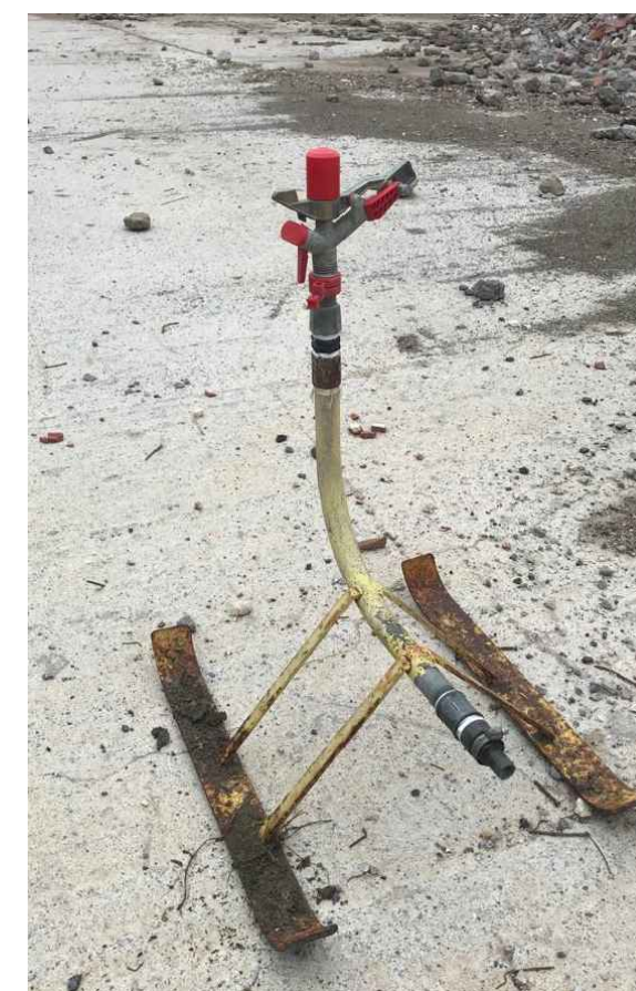
IRRIGATORI SEMOVIBILI, per l'abbattimento delle polveri nei cumuli di stoccaggio
