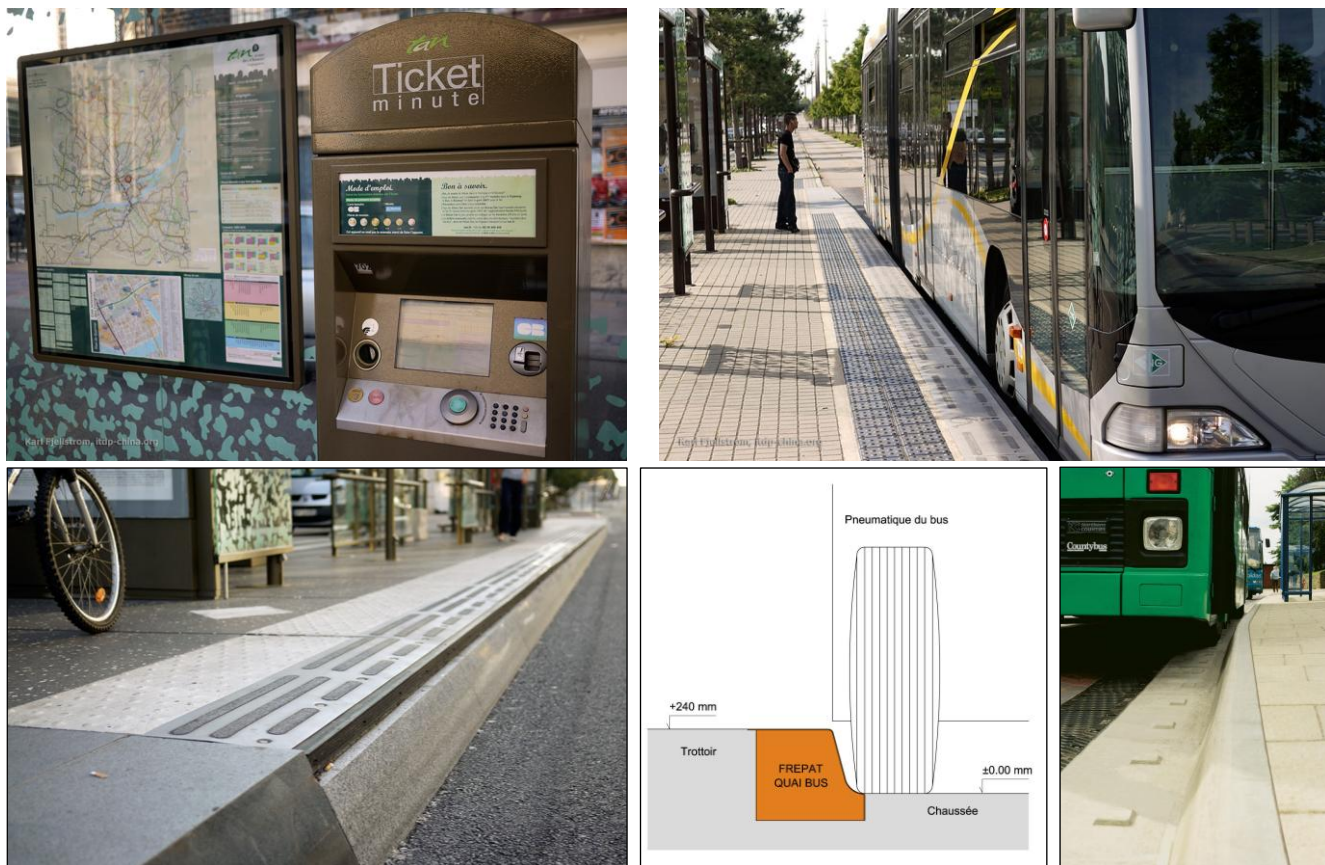
Figura 4-10 Allestimenti delle fermate BRT
