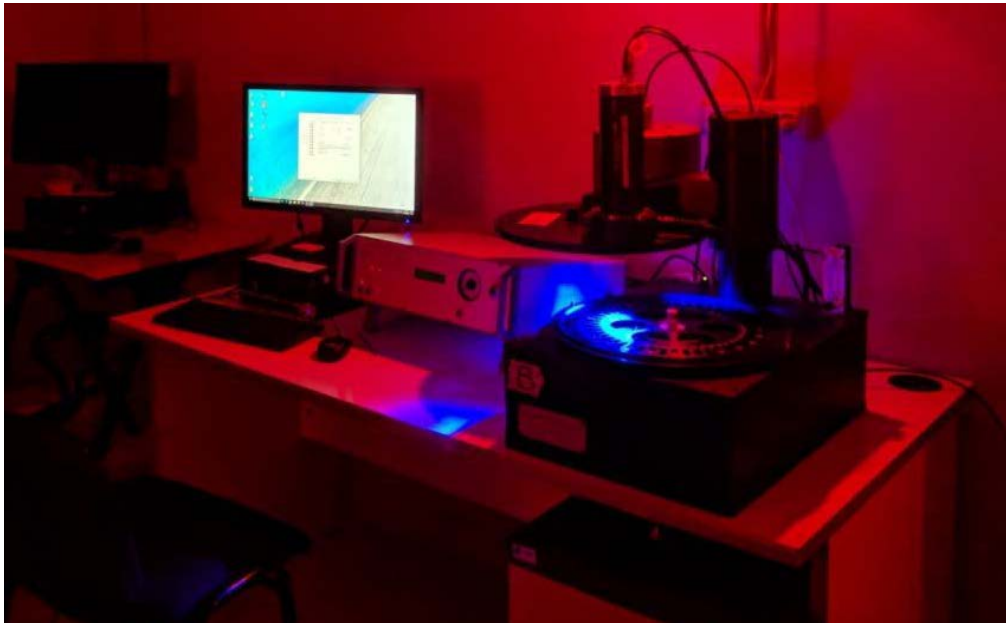
Figura 10. Foto dello strumento per il calcolo della paleodose ( D_e ) in dotazione al laboratorio di datazione tramite luminescenza dell'Università di Sassari. Il laboratorio necessita luce controllata.
