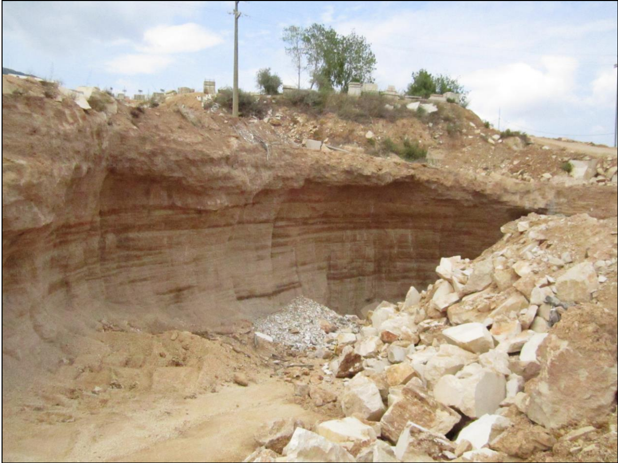
Immagine relativa alla cava attigua della società MARMI ELMO SAS (Si può notare il consistente strato di materiale di ricoprimento del giacimento)
