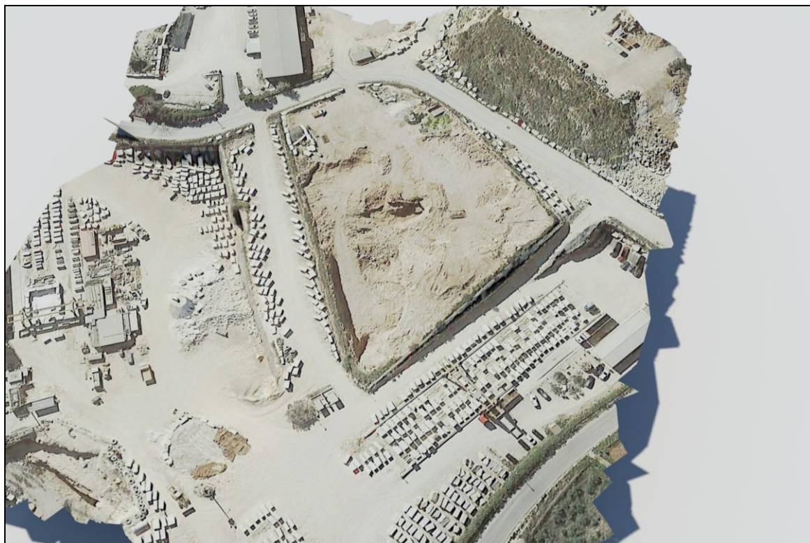
- Modello tridimensionale del terreno allo stato attuale con indicazione di fronti, piazzali e viabilità –
