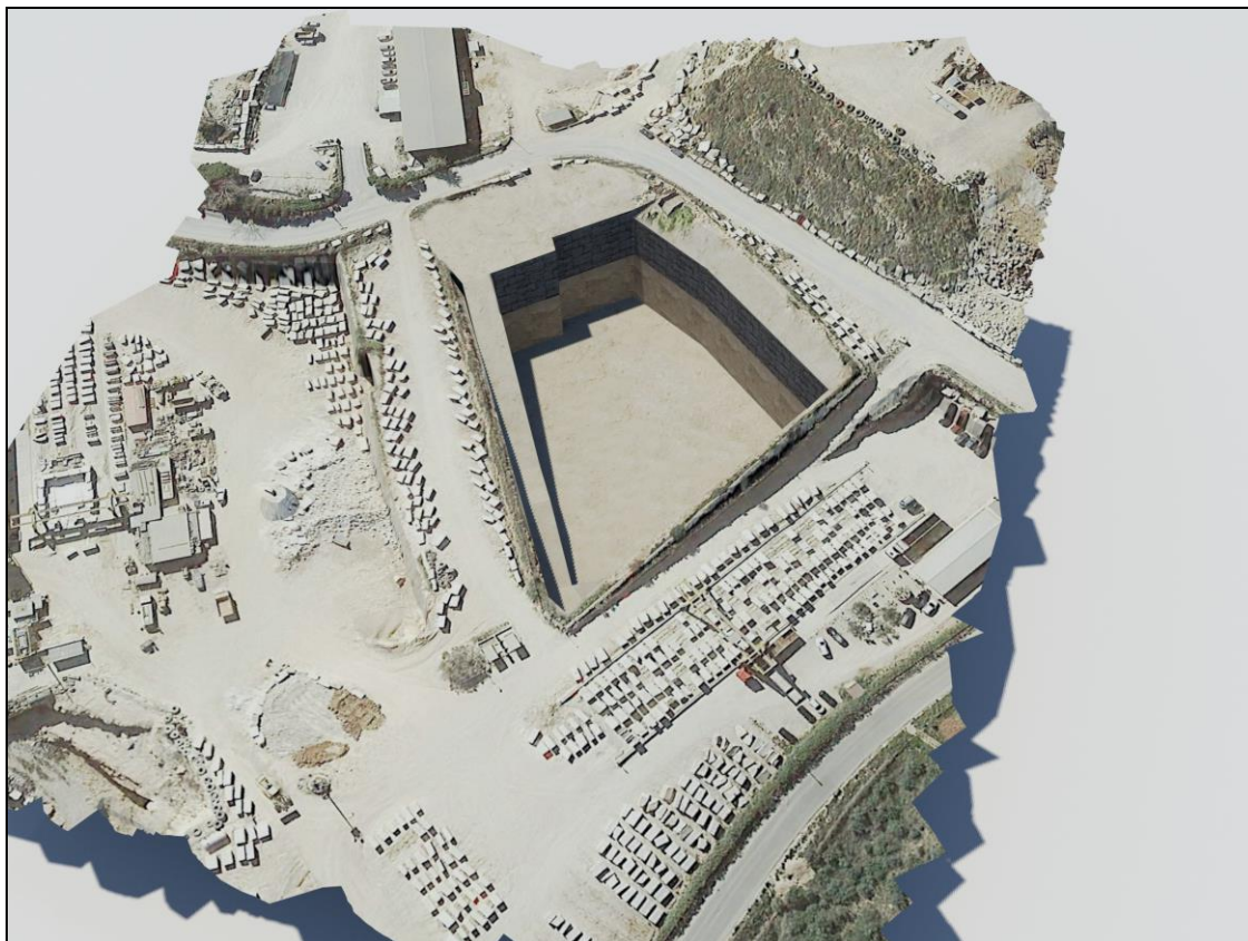
- Planimetria di progetto e simulazione tridimensionale relativa al secondo stato intermedio –
