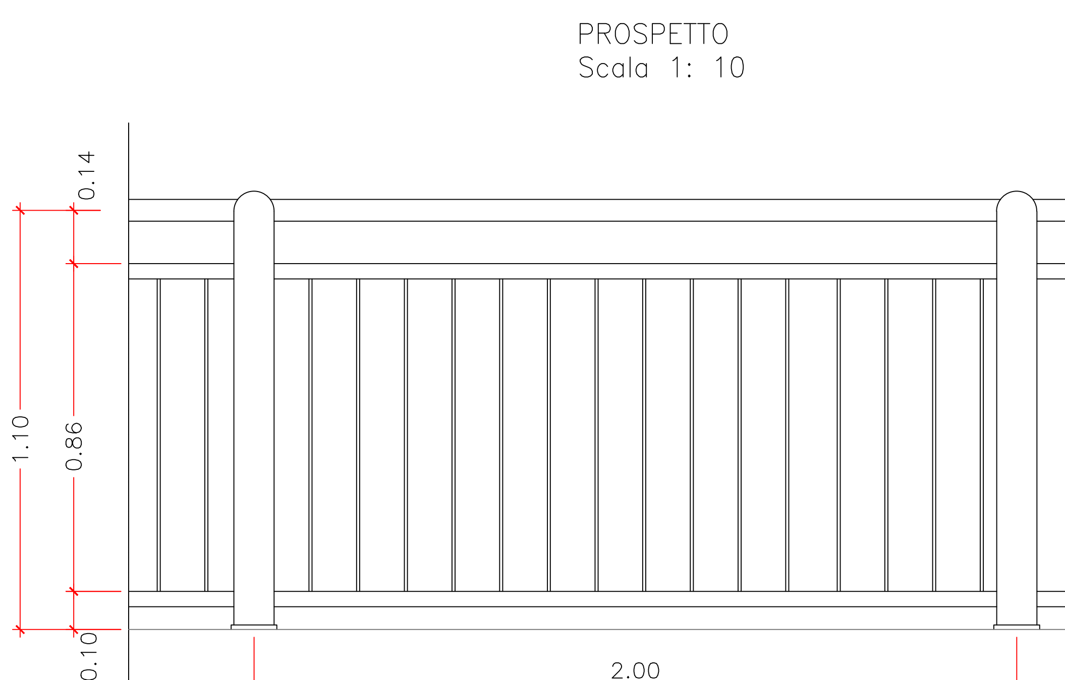
PARTICOLARE PARAPETTO IN ACCIAIO ZINCATO A CALDO E VERNICIATO CON RESINE EPOSSIDICHE
