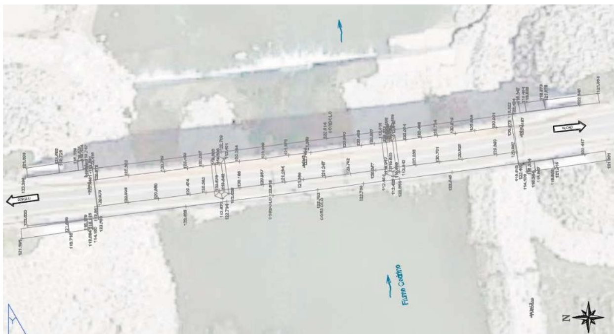
Figura 18 – Vista planimetrica del rilievo celerimetrico del ponte di Oloè.
