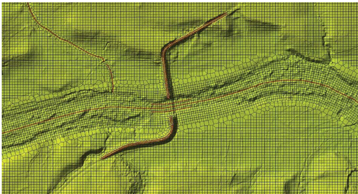
Figura 17 – Estratto della discretizzazione della maglia di calcolo.
