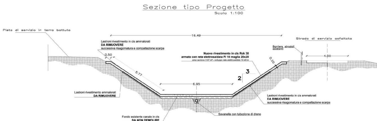
Figura 5 Sezione di progetto del canale a sezione trapezia che necessita di manutenzione
