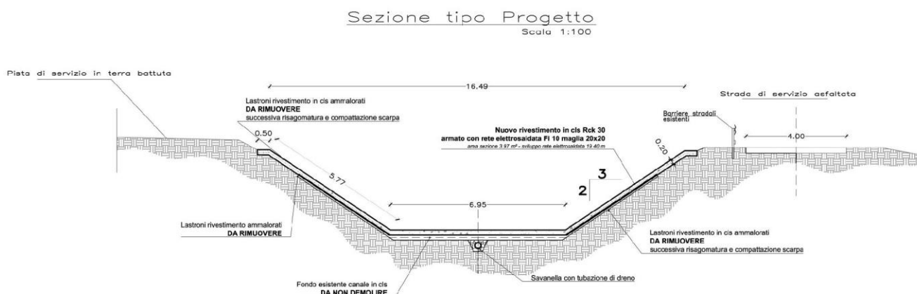
Figura 12 Sezione di progetto del canale a sezione trapezia che necessita di manutenzione
